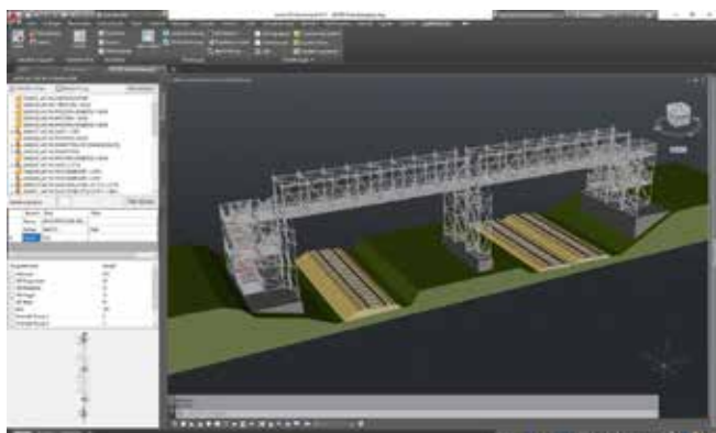
Projektowanie konstrukcji rusztowania w LayPLAN CAD
