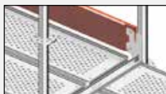
Montaż krawężnika drewnianego
