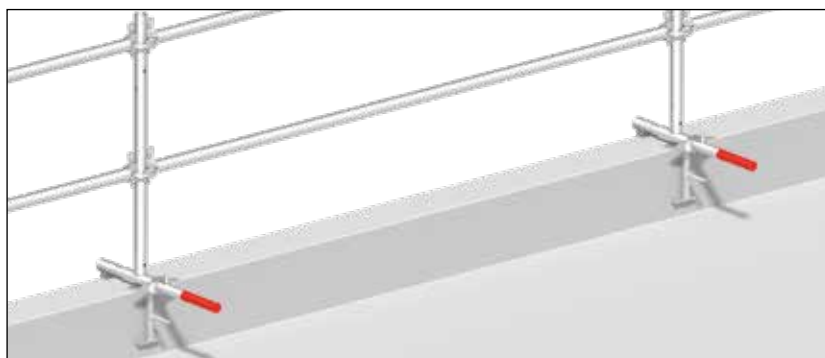
Przykład użycia klamry zaciskowej na attyce
